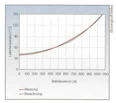
Bild 2 Vergleich Rechnung versus Messung bis ca. 150 °C Seilendtemperatur.
