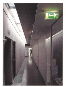
Bild 2 Tageslichtnutzung von oben nach unten durch Glasflächen im Boden der Gänge.
