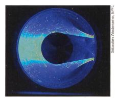
Vue en coupe d'un rhéomètre dans la configuration d'une cellule de couette, dans laquelle un fluide est maintenu entre deux cylindres concentriques. La rotation du cylindre interne entraîne la déformation du fluide (coloré en bleu), rendue visible par le déplacement de particules fluorescentes excitées par les impulsions d'un laser.
