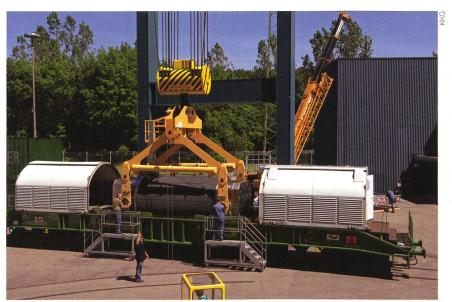
Transportiert und zwischengelagert werden die abgenutzten Brennstäbe in massiven Metallbehältern. Les assemblages combustibles usés sont transportés et stockés temporairement dans des conteneurs métalliques blindés.
