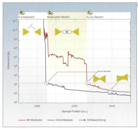
Bild 4 Kontaktierung von Molekülen. Während des Schliessens der Elektroden mit aufgebrachten Molekülen unter gleichzeitigem Messen des Widerstands (konstante Spannung von 5 mV angelegt) tritt ein Zwischenbereich zwischen 1 und 10 M $\Omega$  auf (rote Kurve). Dieser Zwischenbereich tritt ohne Molekül nicht auf (blaue Kurve) und signalisiert damit eindeutig
