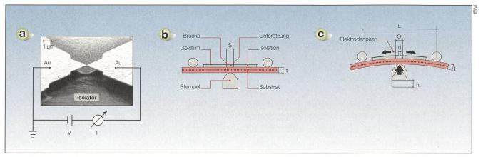
Bild 2 Prinzip der mechanisch kontrollierbaren Bruchkontakte (MCBJ).
