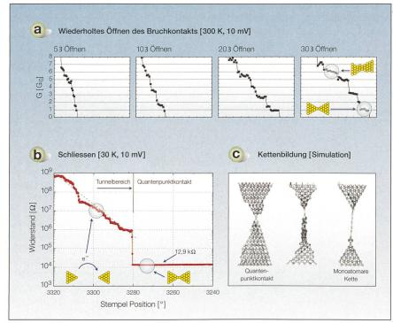
Bild 3 Elastische Eigenschaften eines Bruchkontakts.
