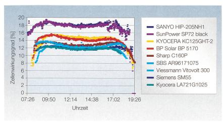
Bild 6 Zellenwirkungsgradverlauf der Solarmodule an schönen Tagen.
