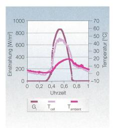
Bild 8 Tagesverlauf der Einstrahlung und der Temperatur.
