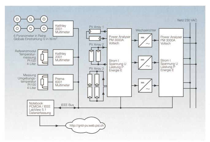
Bild 2 Messsystemaufbau des On-Grid-Systems.
