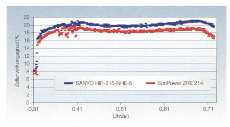
Bild 7 Wirkungsgradvergleich Sanyo-SunPower.
