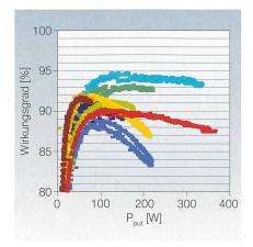
Bild 4 Wirkungsgrade der getesteten Inverter.
