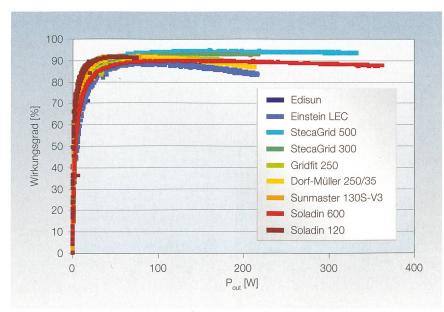
Bild 3 Wirkungsgrade der getesteten Inverter.
