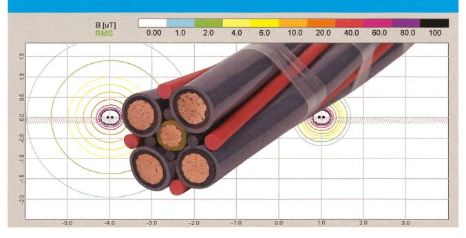
Brugg Cables und CFW EMV-Consulting AG präsentieren Ihnen anlässlich den Powertagen 2008 live den Nutzen des neu entwickelten CFW Power Cable Purwil<sup>®</sup>. Nebst der geringen elektromagnetischen Feldabstrahlung gibt es keine unerwünschten Induktionsströme nach innen oder aussen, noch unter den verseilten Leitern selbst. Keine Induktionsströme bedeuten zudem weniger Verlustleistung, bessere Stromqualität und eine geringere Umweltbelastung. Wir freuen uns auf Ihren Besuch.
