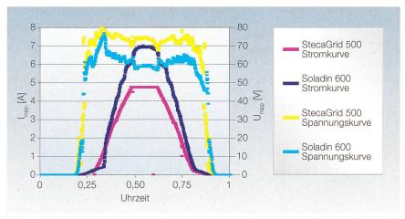
Bild 5 Strom- und Spannungskurve des StecaGrid 500 und des Soladin 600 an einem wolkenlosen Tag.
