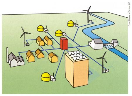
Bild 4 Bildliche Darstellung eines virtuellen Kraftwerkes.
