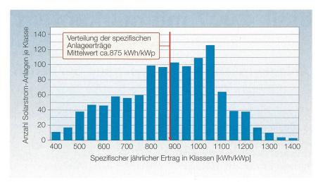
Bild 1 Der mittlere spezifische Jahresertrag der Solarstromanlagen im Jahre 2007 betrug gute 875 kWh/kWp. Er liegt unter anderem dank knapp 3,5% mehr Einstrahlung über dem langjährigen Mittel von 820 kWh/kWp.
