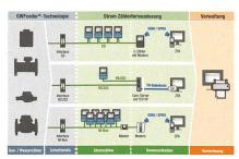
Topologien von GWF zur spartenübergreifenden Auslesung von Strom-, Gas- und Wasserzählern.
