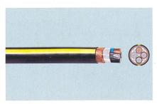
GKN-TNS-Kabel für den 5-Leiter-Hausanschluss mit Aluminium-Polleitern und einem Neutralleiter aus Kupfer.
