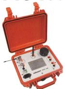
System zur Phasenbestimmung an spannungsführenden Elektroenergie-Systemen
