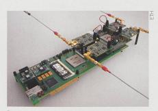
Prototyp einer MIMO-Station mit 4 Antennen (25  $\times$  12 cm gross).
