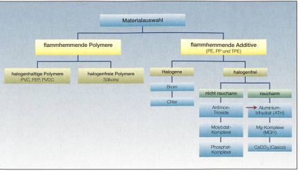
Bild 1 Übersicht von flammwidrigen polymeren Isolier- und Mantelwerkstoffen.
