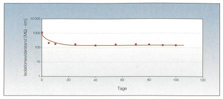
Bild 3 Isolationswiderstand in Wasser.
