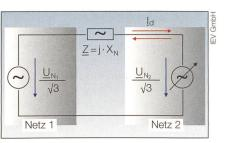
Bild 5 Vereinfachtes Ersatzschaltbild im Mitsystem als einfache Modellierung für die Stromumkehr.
