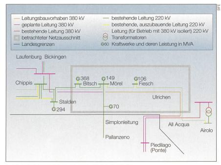
Bild 4 Beispiel eines Netzausschnitts im Bereich Oberwallis.
