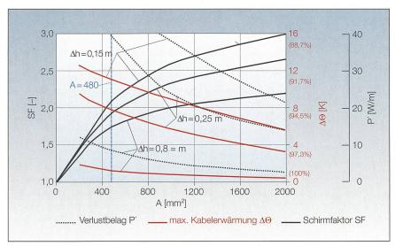
Bild 3 Schirmfaktor SF, Verlustbeläge P' und maximale Kabelerwärmung  $\Delta\Theta$  als Funktion des Gesamtleiterquerschnitts A von vier in einer Ebene um  $\Delta h$  oberhalb des Kabelsystems liegenden Kompensationsleitern gleichen Querschnitts (nur Positions-Optimierung).
