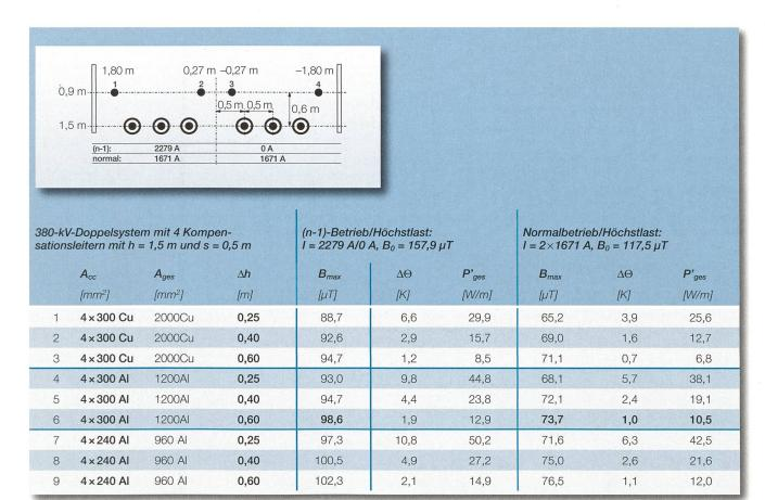
Tabelle 380-kV-VPE-Kabel-Doppelsystem mit vier Kompensationsleitern. Normalbetrieb mit maximalen Lastströmen von jeweils 1671 A (2200 MVA). Höchstwert der magnetischen Induktion an der Erdoberfläche, Kabelerwärmung und Kompensationsleiter-Gesamtverlustbelag im (n-1)-Fall (2279 A; 1500 MVA) und für Höchstlast im Normalbetrieb mit Lastströmen von jeweils 1671 A.
