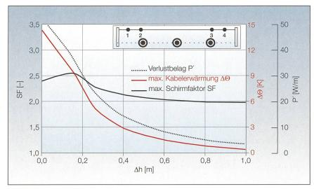
Bild 2 Maximaler Schirmfaktor SF, Verlustbelag P´ und maximale Kabelerwärmung  $\Delta\Theta$  von vier in einer Ebene um  $\Delta h$  oberhalb des Kabelsystems liegenden vier Kompensationsleitern gleichen Querschnitts (4×240 mm²).
