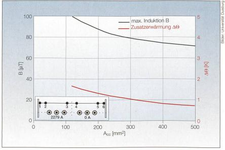
Bild 6 Maximale magnetische Induktion B an der Erdoberfläche und Zusatzerwärmung  $\Delta\Theta$  der mittleren Kabelader des rechten Systems als Funktion des einzelnen Kompensationsleiterquerschnitts  $A_{cc}$  für sechs Kompensationsleiterkabel mit Aluminiumleitern.  $\Delta h = 0.8$  m, (n-1)-Fall: 2279 A/O A.
