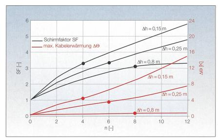
Bild 5 Schirmfaktor SF als Funktion der Anzahl n an Kompensationsleitern mit einem Kupferleiterquerschnitt von jeweils 240 mm² in einer Ebene in der Höhe  $\Delta h$  oberhalb der Kabelebene. Parameter: Höhe  $\Delta h$ .
