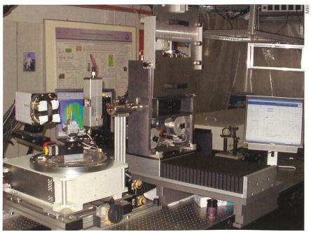
Prototyp für die Femtosekunden-Röntgenbeugung.
