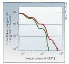
Bild 7 Vermeidung von Blackouts mittels geografischer Umverteilung der Einspeisung und Lastabwurf bei Auftreten von Leitungsüberlasten im schweizerischen Übertragungsnetz.
