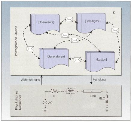
Bild 3 Abstraktion des elektrischen Versorgungssystems durch zwei Modellierungsebenen.
