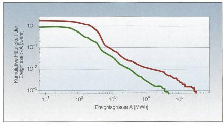
Bild 5 Komplementär-kumulatives Häufigkeits-Ausmass-Diagramm der simulierten Stromausfälle. Die obere Kurve resultiert aus einer Erhöhung des Energieverbrauchs und der Erzeugungskapazitäten um jeweils 20% bei unveränderten Leitungskapazitäten.
