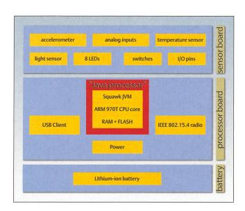
Bild 4 Aufbau der SunSpot-Devices.
