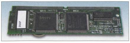
Bild 3 Imsys-Java-Microcontroller auf SNAP-Referenzplattform. Der Chip wurde unterdessen weiter verkleinert.
