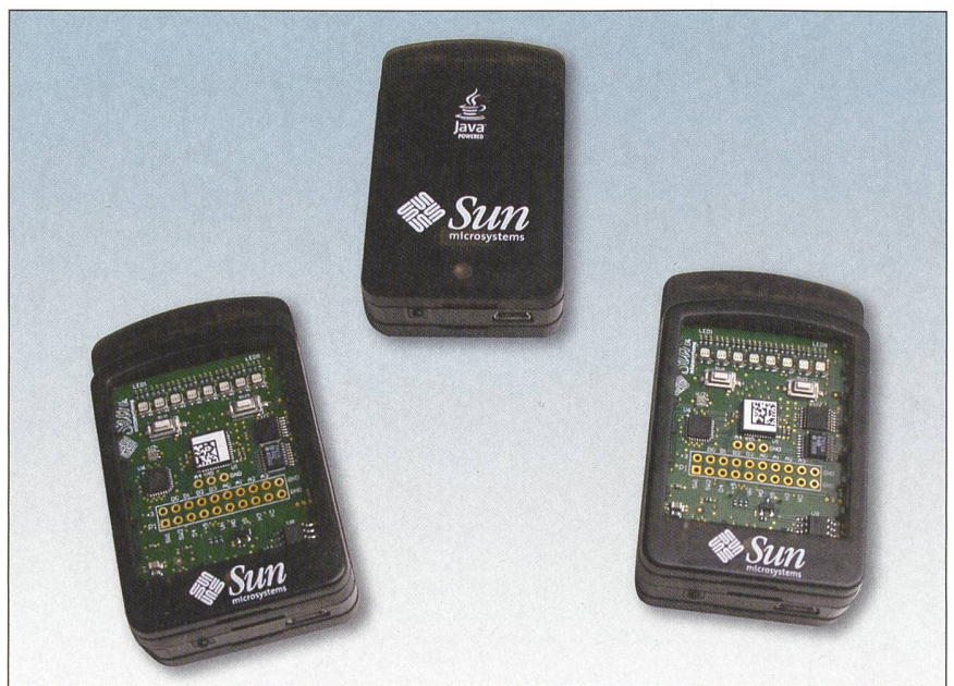
Bild 1 SunSpot-Devices: Spontan drahtlos vernetzte und mobile Java-Kleinstcomputer auf hohem Leistungsniveau.
