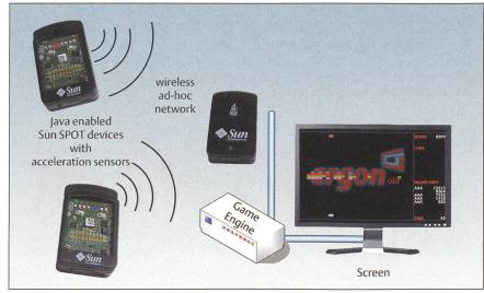
Bild 5 Zusammenspiel der Devices im Ergonoid-System.
