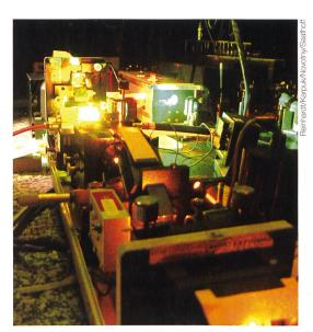
Ansicht der Versuchsapparatur: Farbstofflaser (orange) mit Pumplaser (grün).
