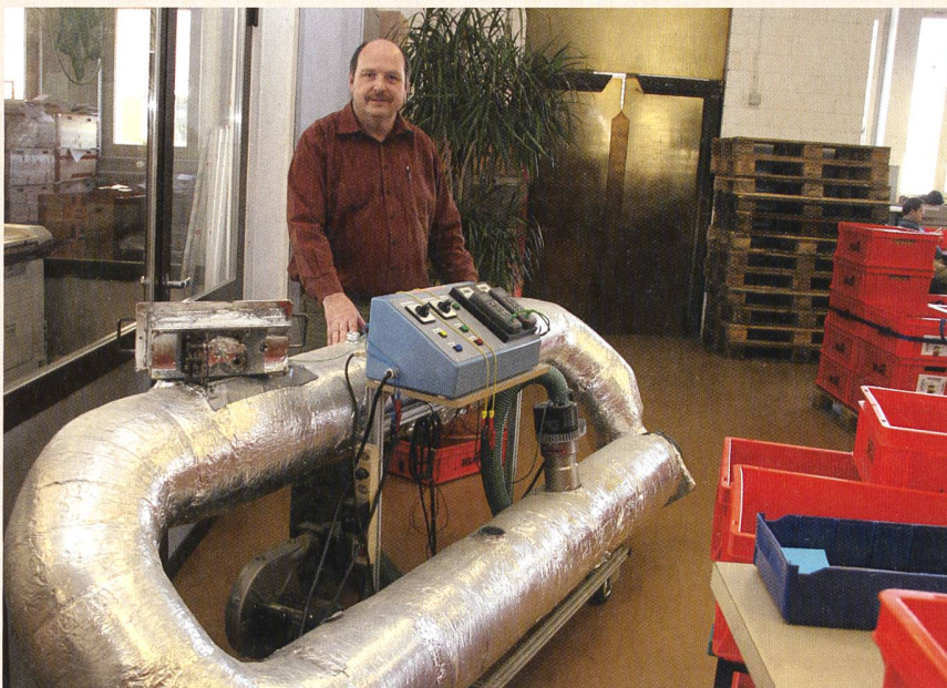
Qualitätskontrolle wird auch in der Sonnhalde-Werkstatt grossgeschrieben. Max Kunz vor dem Testgerät für die Belimo-Thermoelemente – liebevoll Ufo genannt –, an dem mit genau vorgeschriebenen Stichproben sichergestellt wird, dass die Auslösung bei exakt 72 °C geschieht.
