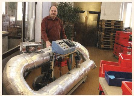
Qualitätskontrolle wird auch in der Sonnhalde-Werkstatt grossgeschrieben. Max Kunz vor dem Testgerät für die Belimo-Thermoelemente – liebevoll Ufo genannt –, an dem mit genau vorgeschriebenen Stichproben sichergestellt wird, dass die Auslösung bei exakt 72 °C geschieht.
