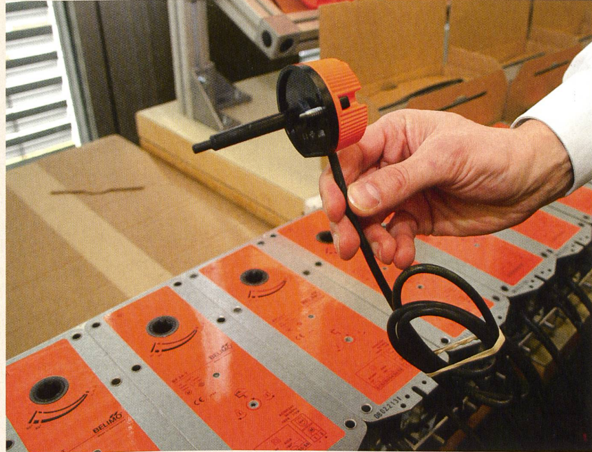
Die fertigen Brandschutzklappenantriebe mit den Thermoelementen aus der Sonnhalde – bereit für die Auslieferung nach ganz Europa.
