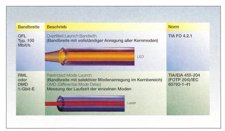
Bild 2 Der Unterschied zwischen OFL- und RML-Bandbreite.
