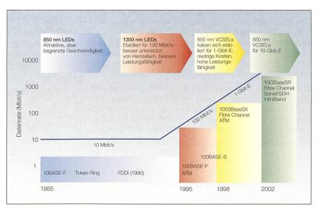
Bild 1 Entwicklung der Übertragungssysteme und Standards bei LWL.
