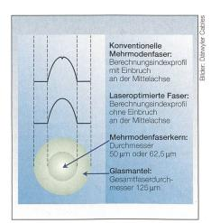
Bild 3 Brechungsindex einer laseroptimierten Faser.
