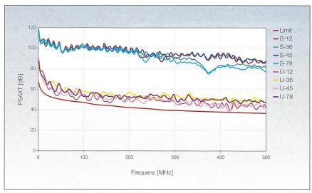
Bild 3 Vergleich geschirmte/ungeschirmte Kabel.
