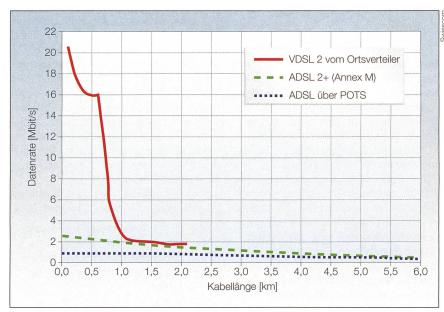
Bild 3 Upstream-Bitraten von DSL-Technologien.
