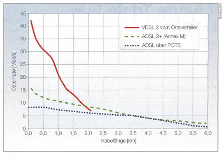
Bild 2 Downstream-Bitraten von DSL-Technologien
