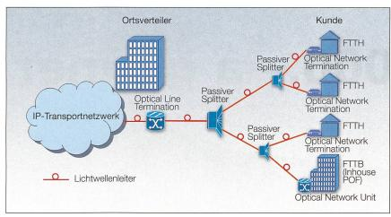
Bild 5 Einsatzmöglichkeiten von passiven optischen Netzen im Anschlussnetz.
