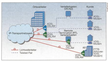
Bild 4 Einsatzmöglichkeiten von DSL im Anschlussnetz.
