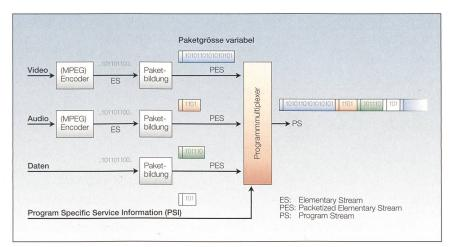
Bild 8 Aus den Elementarströmen wird der Programmstrom zusammengesetzt.
