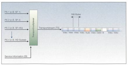
Bild 9 Mehrere Programmströme werden zu einem Transportstrom zusammengesetzt.
