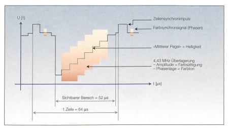
Bild 4 FBAS-Signal (Composite).
