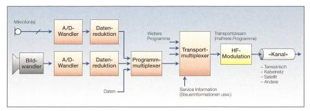
Bild 5 Digitale Fernsehübertragung.
