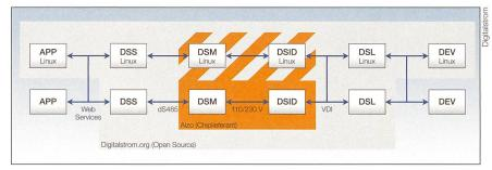
Bild 2 Die verschiedenen Komponenten von Digitalstrom.
