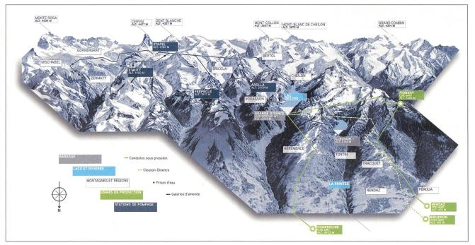
Figure 2 Grâce à un bassin versant de 420 km², la retenue de la Grande Dixence dispose de 400 millions de m³ d'eau qui sont autant d'énergie potentielle.
