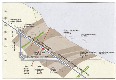
Figure 1 Afin de garantir une sécurité maximale, la zone de l'accident sera contournée sur une longueur de 117 m par un by-pass profond.
