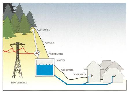
Beyor das Quellwasser ins Reservoir fliesst, kann es zum Antrieb einer Turbine genutzt werden.
