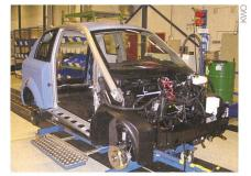
Rohbau mit Zellstruktur und Aufprallschutz.
