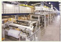
Profinet IRT synchronisiert die 100 m lange Beschichtungsmaschine auf 1 ms genau.
