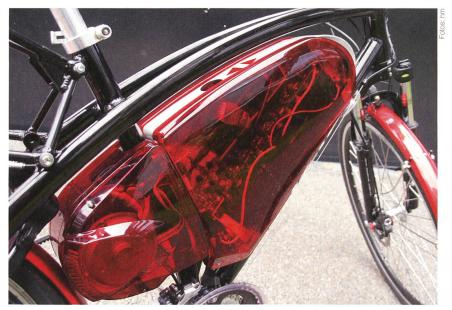
«Durch»-Blick ins Powerset des Dolphin: links Motorunit (Antrieb mit Zahnriemen aufs Hinterrad), rechts die Powerbox mit den Akkus, der Steuerung und dem integrierten Ladegerät.
