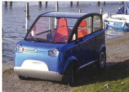
Prototypenfahrzeug, um zu zeigen, dass 350 kg für ein Elektromobil reichen.
