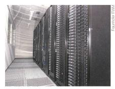
Der neue Höchstleistungsrechner Herkules besteht aus 272 Einzelrechnern.
