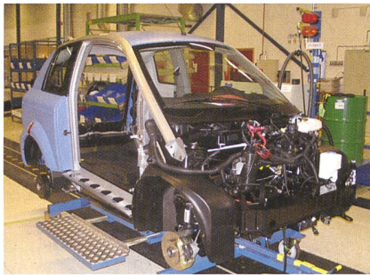
Rohbau mit Zellstruktur und Aufprallschutz.
