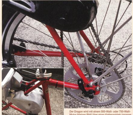
Motor (kleines Bild) über einen Kettenantrieb (grosses Bild) in Gang gesetzt.
