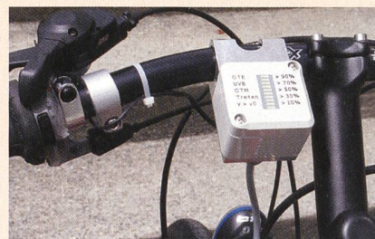
Sollte man bei Elektrofahrrädern immer im Blickfeld haben: Ladestandsanzeige des Akkus.
