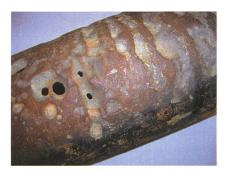
Bild 4 Korrosion durch Stromeinwirkung an einem duktilen Gussrohr.
