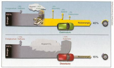
Bild 1 Effizienzvorteile des Elektroantriebs: Energiekette.
