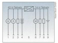
Bild 7 Zwei-Spannungs-Bordnetz nach [5]. 1: Generator (G); 2: Starter (S); 3: Verbraucher; 4: Batterie; 5: Wandler 42/14 V; 6: Motor; 7–8: Verbrauchergruppen; 9: Batterie.
