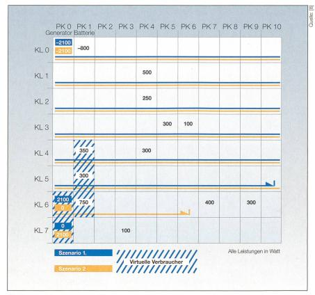
Bild 5 Datenstruktur des Energiemanagementansatzes.
