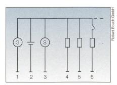
Bild 1 Schematische Darstellung eines 14-V-Bordnetzes.
