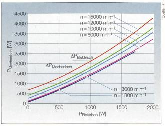
Bild 4 Mechanische Leistung P<sub>Mechanisch</sub> eines Generators in Abhängigkeit der elektrischen Leistung P<sub>Elektrisch</sub>.
