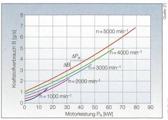
Bild 3 Kraftstoffverbrauch B in Abhängigkeit der Motorleistung P<sub>e</sub> (Willans-Linien).
