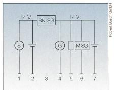
Bild 6 Zwei-Batterie-Bordnetz nach [5]. 1: Starter (S); 2: Starterspeicher; 3: Bordnetz-Steuergerät (BN-SG); 4: Generator (G); 5: Verbraucher; 6: Motor-Steuergerät (M-SG); 7: Versorgungsbatterie
