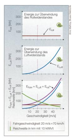
Bild 2 Energiebedarf an der Antriebswelle pro km und t bei unbeschleunigter Geradeausfahrt in ebenem Gelände.
