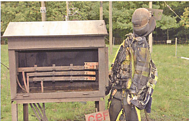
Richtige Arbeitskleidung: Verheerende Folgen nach einem Kurzschluss.
