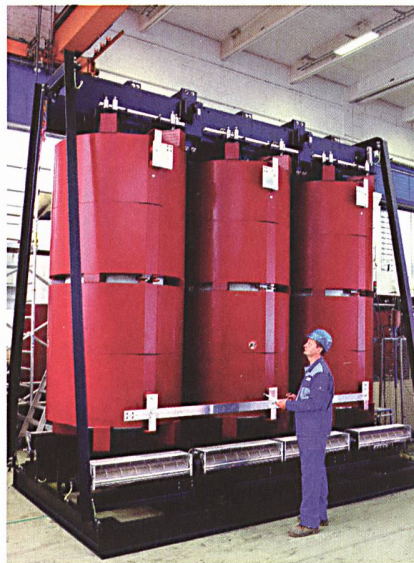
Ein ungewöhnlich grosser Giessharztransformator mit einer Nennleistung von 40 MVA.
