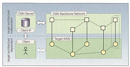
Figure 4 Architecture du réseau de support au déploiement.
