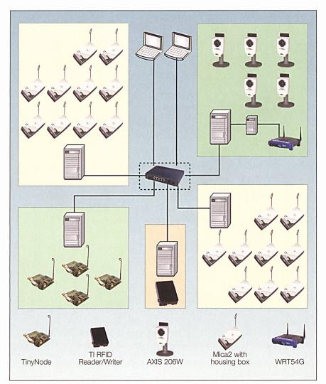
Figure 5 Une configuration des capteurs globaux (GSN) typique.
