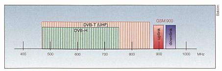
Bild 2 Frequenzbereich von DVB-H.
