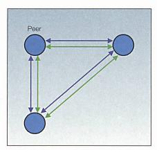
Bild 3 Verteiltes Peer-to-Peer-Netz.
