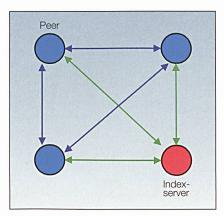
Bild 2 Zentralisiertes Peer-to-Peer-Netz.
