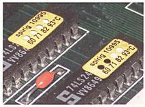
MicroCelsi-Etiketten von Spirig: Das IC rechts hat die Temperatur von 71  $^{\circ}\text{C}$  erreicht, jedoch nie 82  $^{\circ}\text{C}.$
