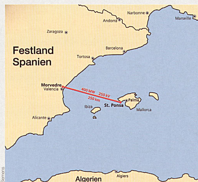
Die 250 km lange Seekabelverbindung wird von Mai 2011 an zwischen Morvedre bei Valencia und Santa Ponsa bei Palma de Mallorca 400 MW mit einer Übertragungsspannung von 250 kV verlustarm übertragen.
