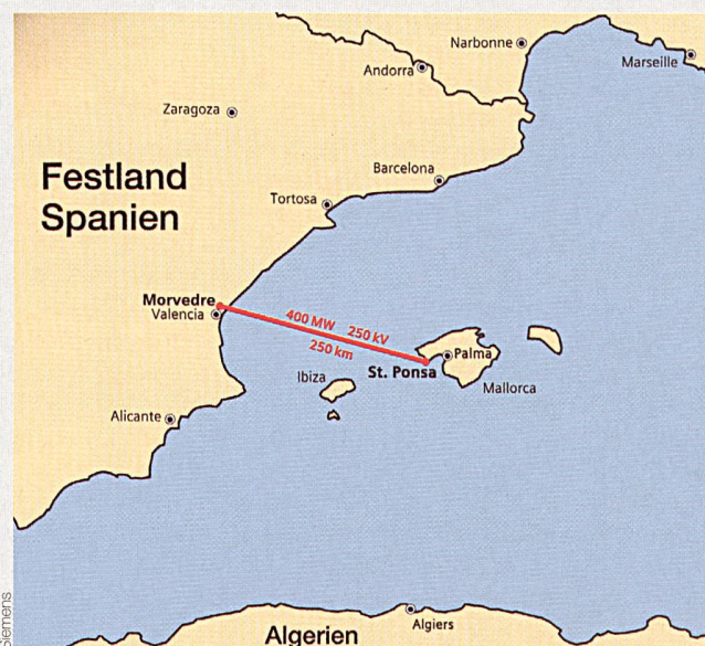
Die 250 km lange Seekabelverbindung wird von Mai 2011 an zwischen Morvedre bei Valencia und Santa Ponsa bei Palma de Mallorca 400 MW mit einer Übertragungsgleichspannung von 250 kV verlustarm übertragen.
