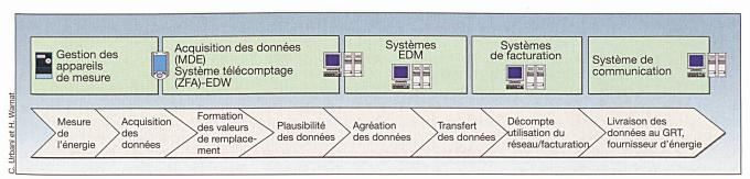
Figure 2 Mise à disposition des données de mesure chez le gestionnaire du réseau de distribution.
