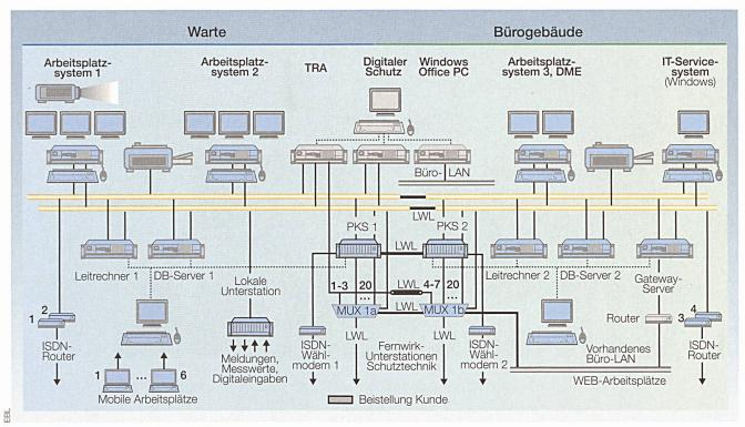
Bild 2 Aufbau des Netzleitsystems bei EBL.
