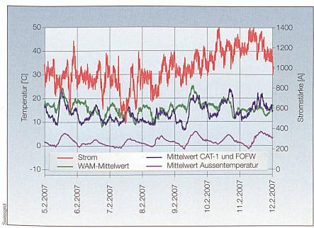
Bild 8 Mittelwerte der Seil- und Aussenlufttemperatur.
