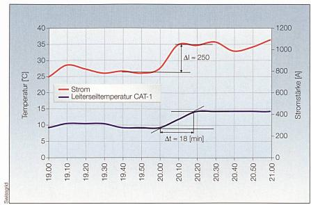
Bild 10 Messung der thermischen Leiterseilzeitkonstante.
