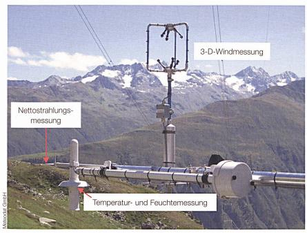
Bild 7 Meteorologische Messstation auf dem Leiterseil
