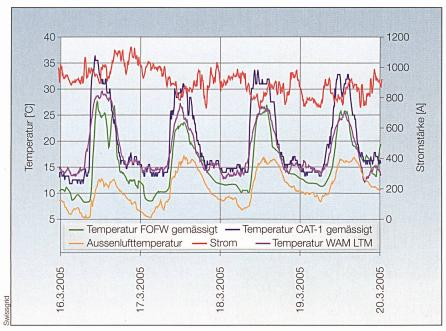
Bild 9 Darstellung der Messungen der Station 1 in Erstfeld.
