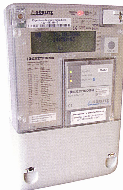
Der Echtzeitähler Emetrion IQ von Görlitz mit Zulassung von der Physikalisch-Technischen Bundesanstalt (PTB).
