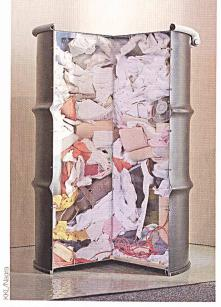
Beim Betrieb der Kernkraftwerke fallen unter anderem Schutzanzüge, Schuhe, Putzmaterial, Folien und kontaminierte Metallteile und Luftfilter als schwachaktiver Abfall an.
