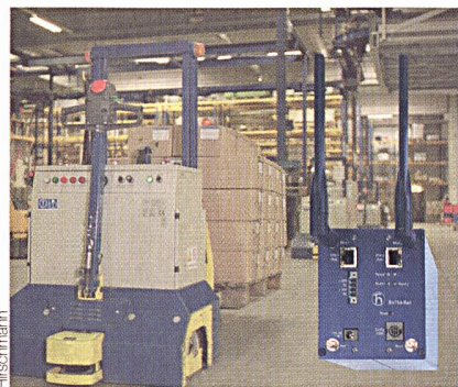
Der intelligente Hubstapler ist drahtlos vernetzt.
