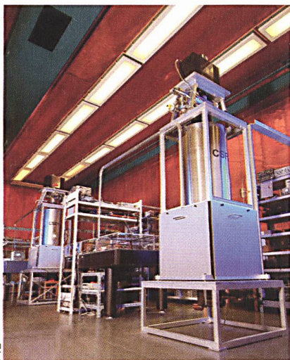
Die beiden Caesium-Fontänenuhren in der Urennhalle der PTB Braunschweig gehören zu den derzeit genauesten Uhren der Welt.
