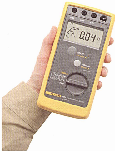
Erdungsmesser Fluke 1621: tragbar und robust.
