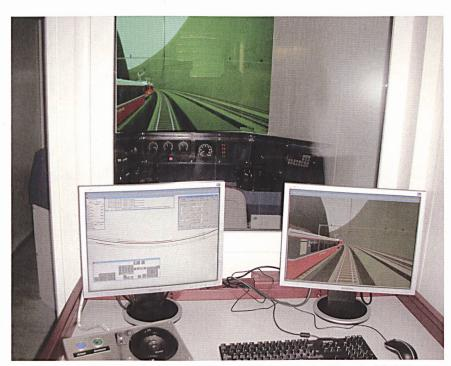
Im Vordergrund der Instruktorenplatz; im Hintergrund, hinter der Glasscheibe, das Führerpult mit Projektion des Führerstandausblicks.
