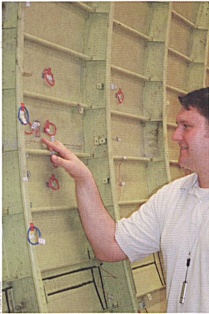
Piezosensoren überwachen den Flugzeugrumpf – und melden kleine Risse
