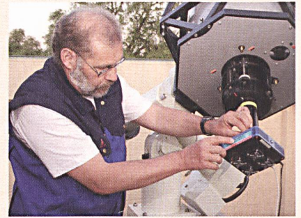
Das 40-cm-Friedrich-Meier-Teleskop eignet sich in Kombination mit der hochempfindlichen CCD-Kamera hervorragend für die Beobachtung und Vermessung von Kleinplaneten. Die Kamera wird vom PC aus programmiert und liefert dann die gewünschte Anzahl Bilder in den vorgegebenen Zeitabständen – üblicherweise 40 je 30 Sekunden lang belichtete Frames mit Abständen von 10 Sekunden.
